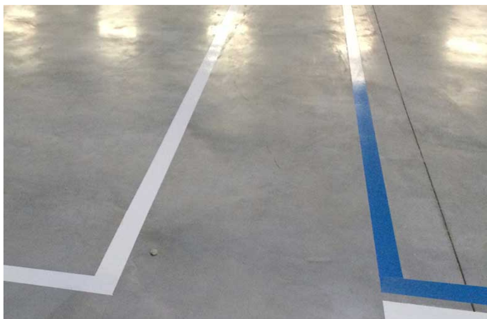
Exemple d'utilisation du ruban pour réaliser un marquage au sol dans un entrepôt
